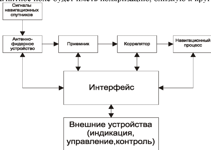
Рис. 4.19. Обобщенная схема аппаратуры потребителя
