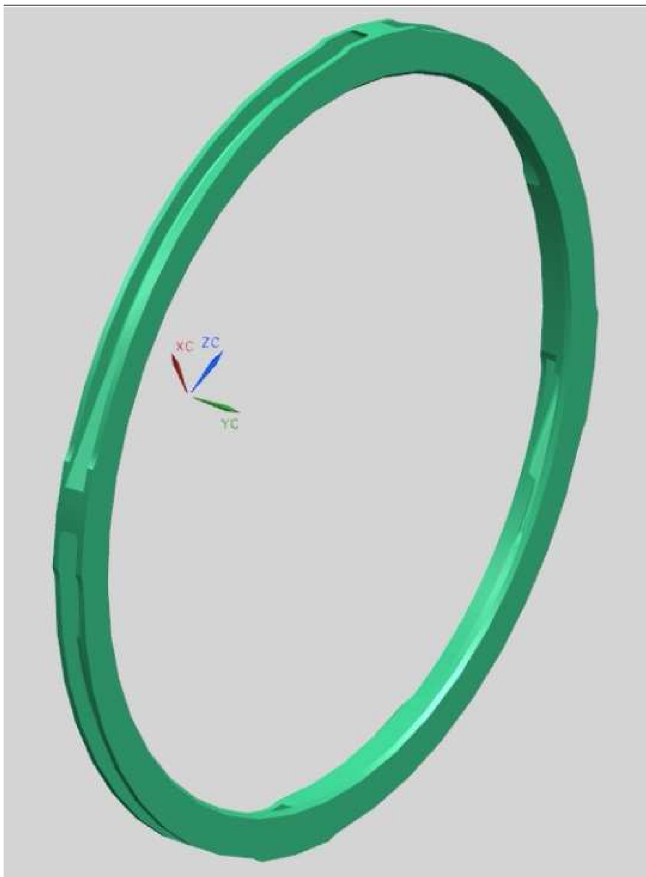
Рисунок 1.14 – Кольцо с четырьмя каналами
