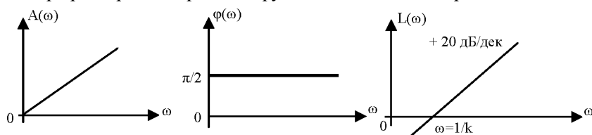
Рис. 17. Характеристики дифференцирующего звена
