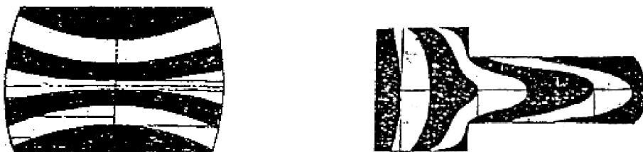
Рис.6. Неравномерность деформации при осадке и прессовании
