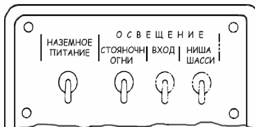
Рис. 71. Органы управления внешним светотехническим оборудованием
