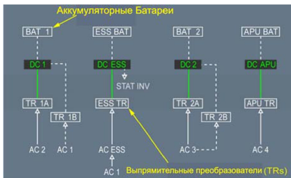
Система генерирования постоянного тока
