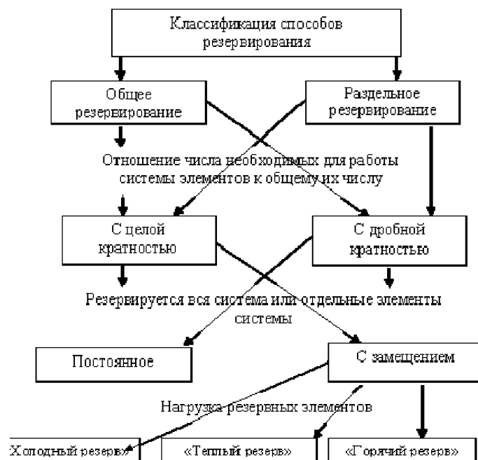
Рис. 11. Классификация способов структурного резервирования
