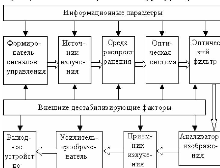
Рис. 1 - Обобщенная структура оптоэлектронного устройства
