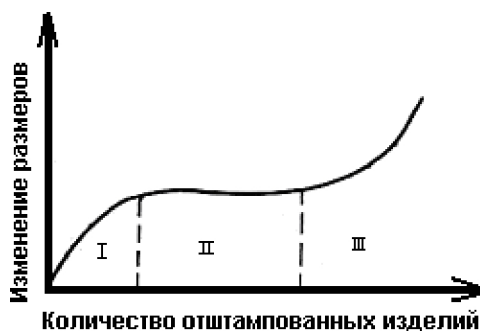
Рис. 15. Характер изменения размеров инструмента от количества отштампованных изделий
