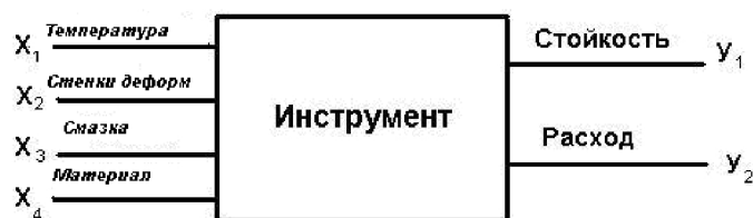
Рис. 7. Блок-схема эксплуатации штампа в процессе горячей штамповки
