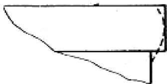
Рис. 26. Профиль пресс-шайбы: — до прессования, ----- после прессования
