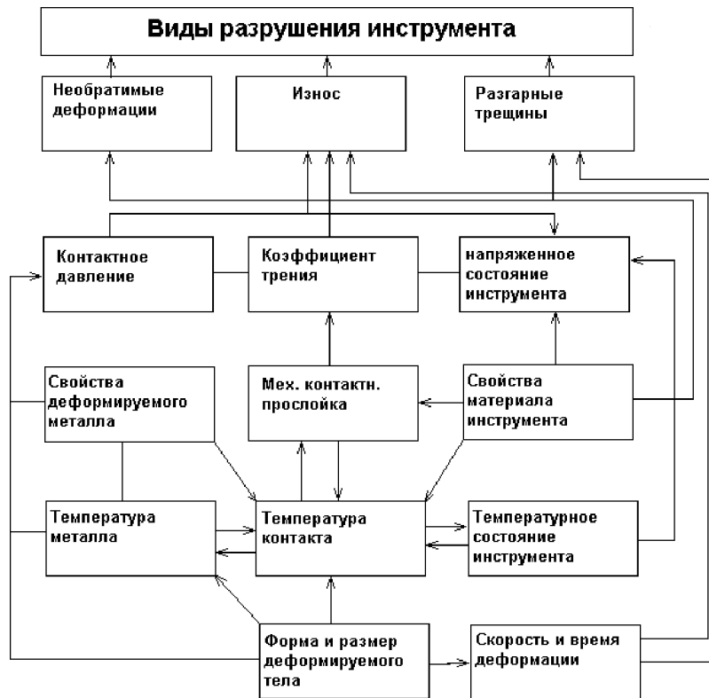
Рис. 5. Схема доминирующих факторов разрушения инструмента
