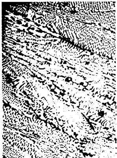
Рис. 7. Ледебурит, х 500-эвтектическая смесь, состоящая из округлых темных включений перлита на светлой основе цементита; содержит 4,3 % С; образуется при 1147 °С из жидкости
