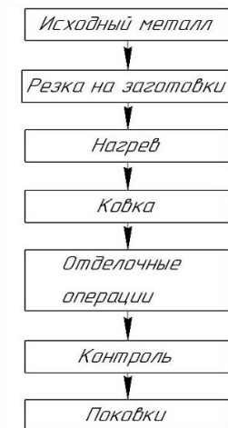
Рис. 1. Схема технологического процесса ковки поковок
