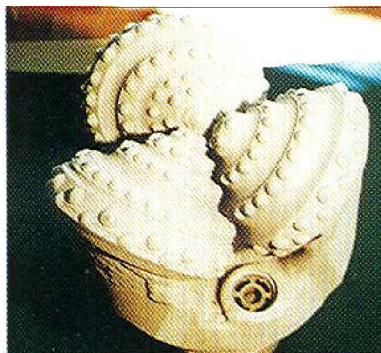
Породоразрушающий инструмент с износостойким покрытием
