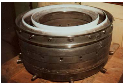
Камера сгорания ГТД с теплозащитным покрытием
