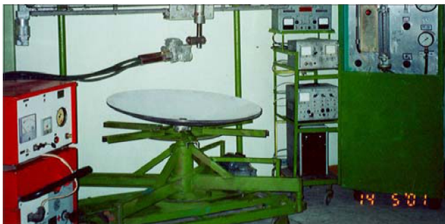
Мобильная малогабаритная установка для плазменного напыления коррозионностойких покрытий на лопатки турбин ТЭЦ без их демонтажа
