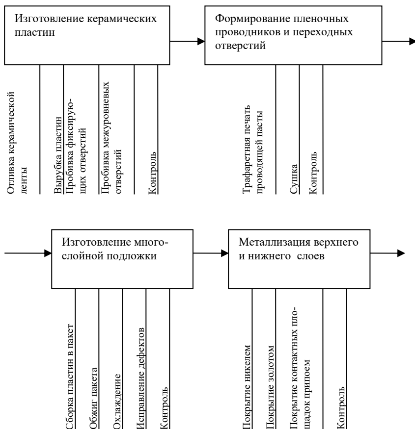
Рис. 35. Технологический маршрут изготовления многослойной керамической подложки
