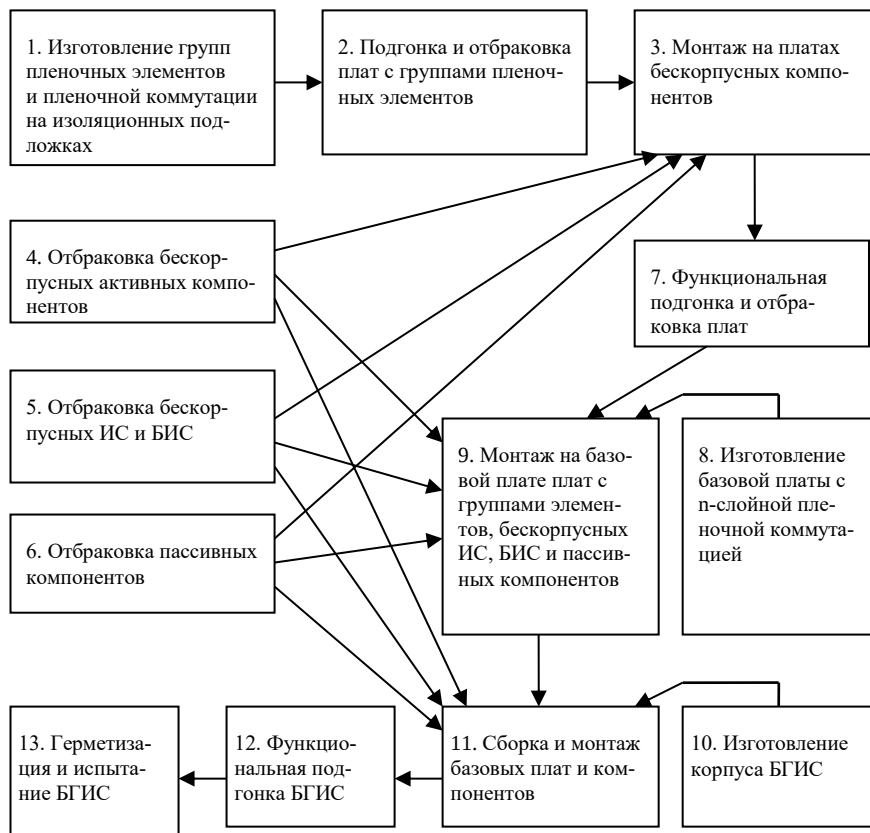
Рис. 4. Укрупненная схема технологического процесса изготовления БГИС
