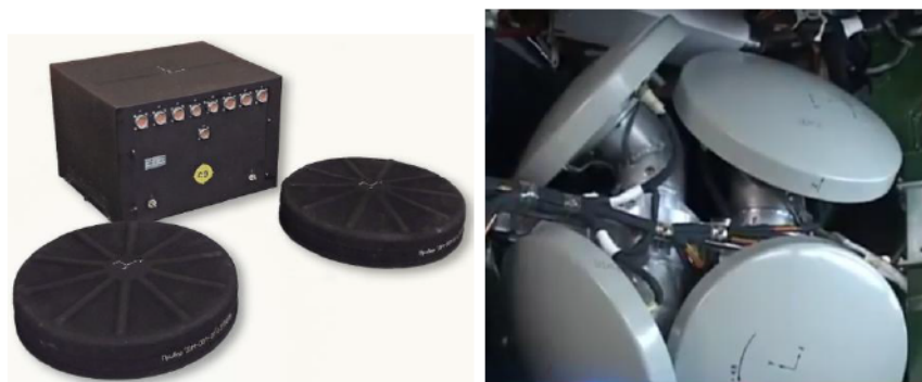
Рис. 10.21. Система двигателей-маховиков КА «ГеоИК-2» [77]
