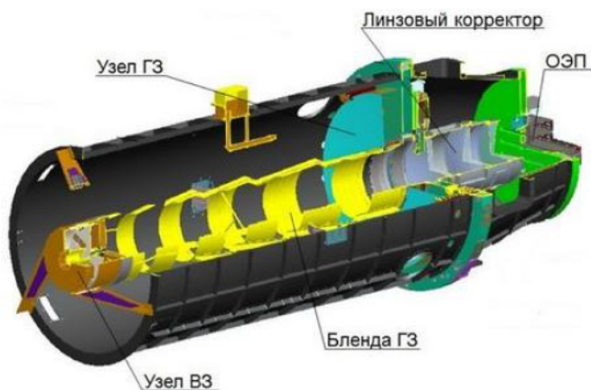
Рис. 8.13. Твёрдотельная модель телескопа ОЭК ВР [34]
