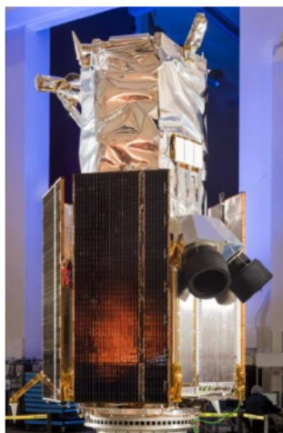
Рис. 15.25. Схема установки панелей СБ на КА ДЗЗ «WorldView-4»
