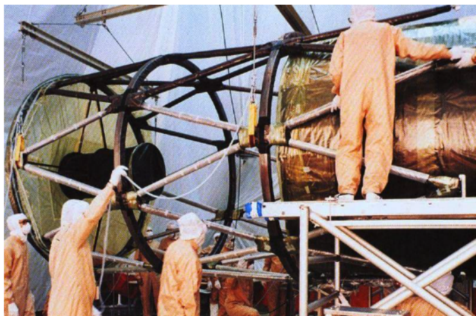
Рис. 8.12. Элементы силовой конструкции телескопа [106]
