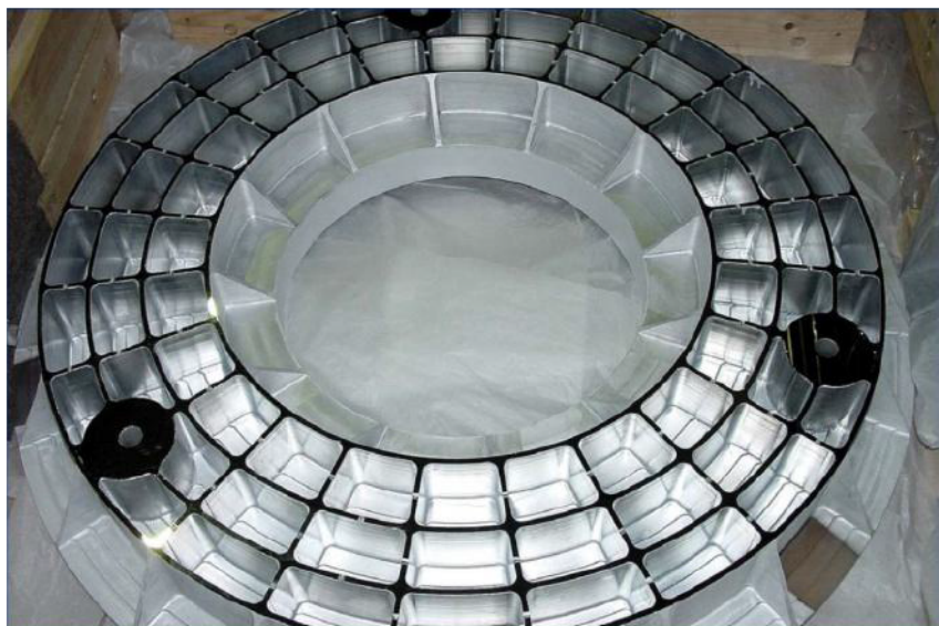
Рис. 8.9. Конструкция главного зеркала [68]
