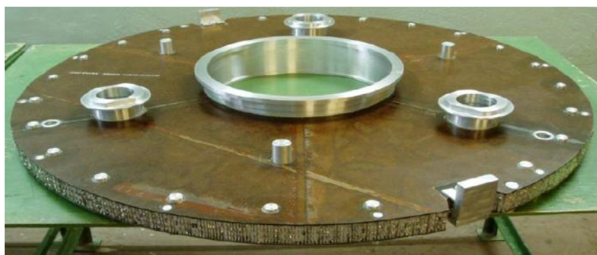
Рис. 8.10. Конструкция платформы главного зеркала [69]
