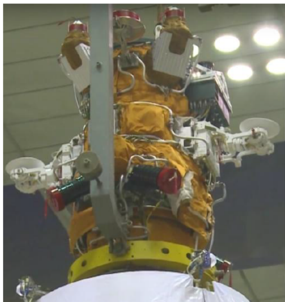
Рис. 15.28. Внешние устройства КА ДЗЗ «Ресурс-П» вблизи отсека ОЭТК
