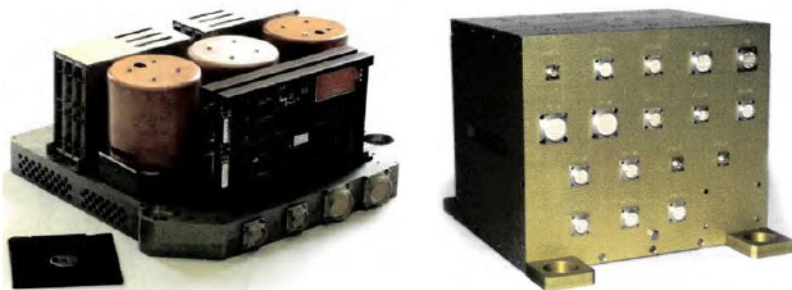
Рис. 10.14. Блоки бескарданной инерциальной системы на базе электростатических гироскопов [61]
