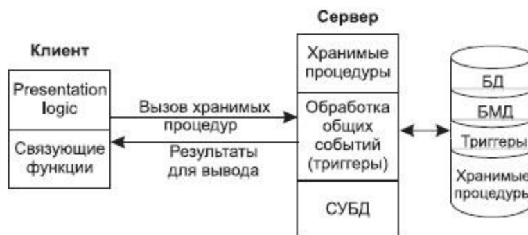
Рисунок 4.5 - Модель активного сервера БД
