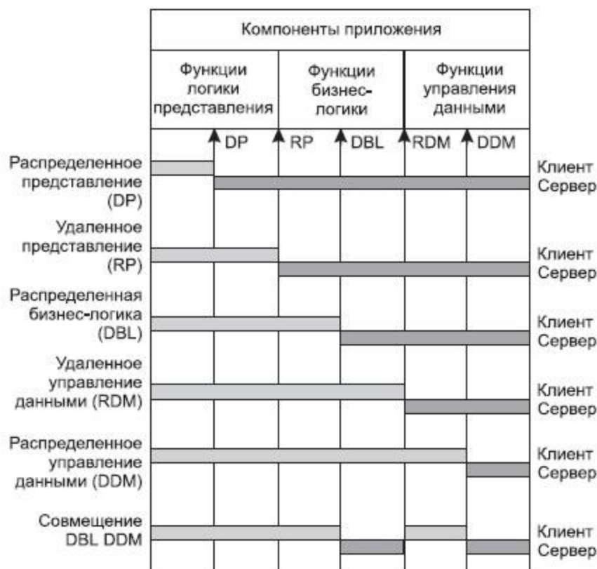
Рисунок 4.2 - Распределение функций приложения
