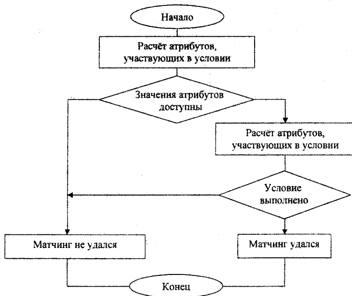
Рис. 10. Алгоритм проверки условий матчинга
