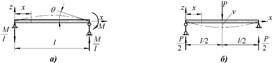
Рисунок 2.10 – Примеры определения перемещений по теореме Кастильяно
