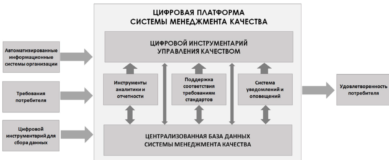
Рис. 2 – Структурная модель цифровой платформы системы менеджмента качества
