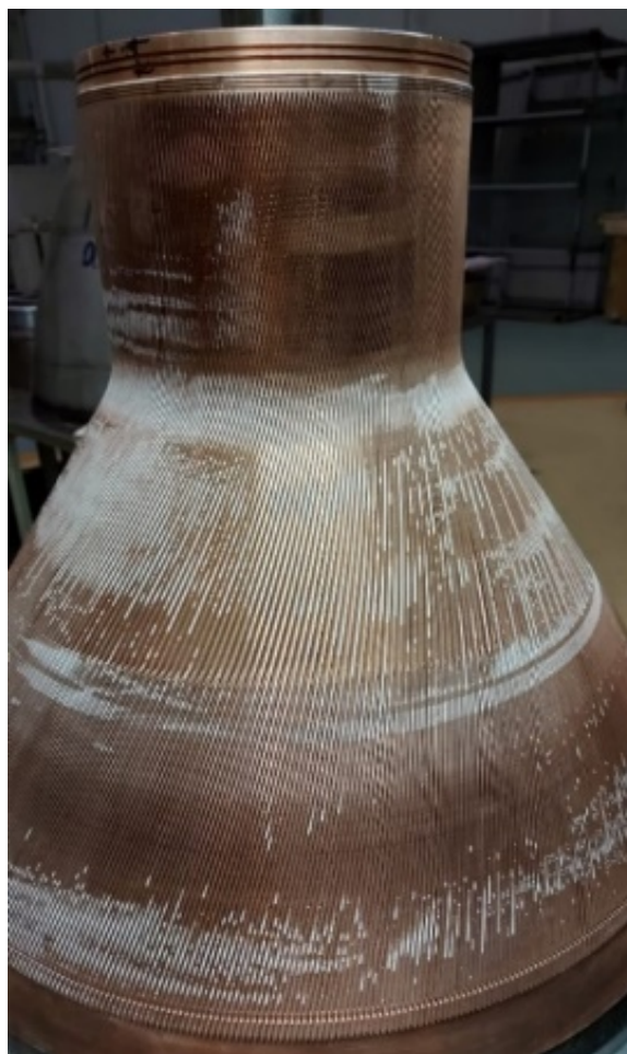
Рис. 2 – Внутренняя стенка камеры после проверки на прилегание при помощи мелового раствора
