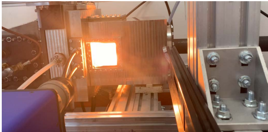
Рис.1 – Фотография отсека для испытаний фронтных устройств при повышенном давлении
