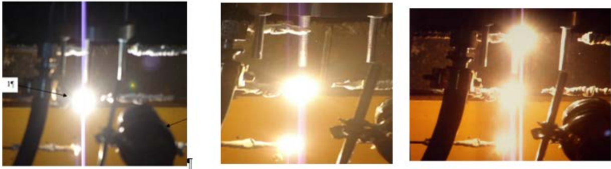
Рис.2 - Экспериментально полученные множественные плазменные образования по ходу одного лазерного луча в атмосферных условиях
