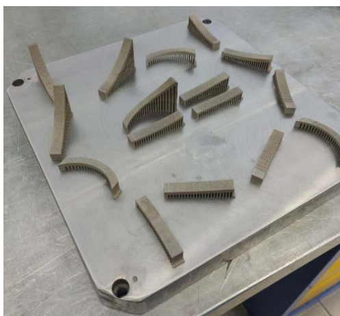
Рис. 1 – Расположение образцов на платформе построения (а) и образцы, изготовленные методом СЛС из порошка нержавеющей стали 12Х18Н10Т (б)
