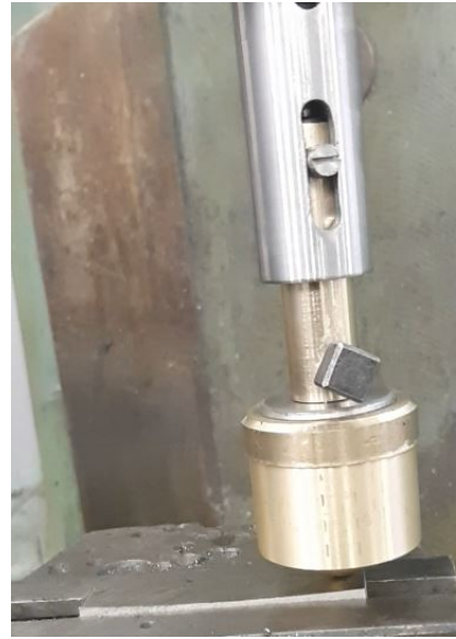
Рис. 1 – Приспособление для выглаживания: а – компоновка (3D-модель); б – общий вид; в – процесс выглаживания криволинейной поверхности
