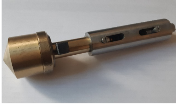
Рис. 1 – Приспособление для выглаживания: а – компоновка (3D-модель); б – общий вид; в – процесс выглаживания криволинейной поверхности
