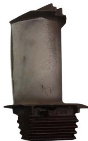
Рис. 2 – Структура термоисторической краски после 50 часовых испытаний
