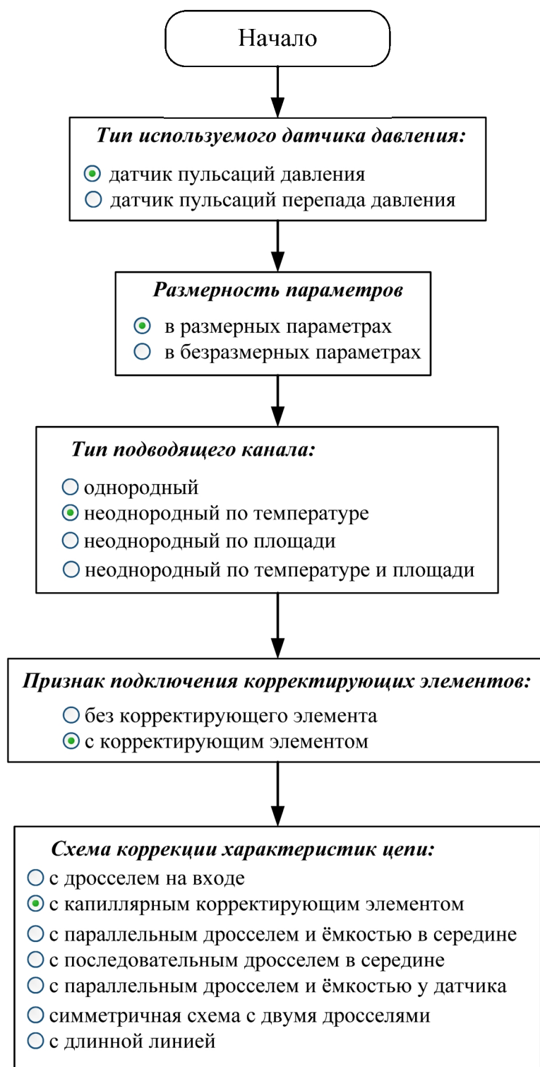
Рис. 2.4.1. Блок-схема программы расчёта частотных характеристик акустической измерительной цепи РУДИП (см. также с. 66)
