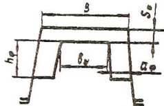
Рис. 4.5. Профиль швеллерного типа с открытыми фланцами
