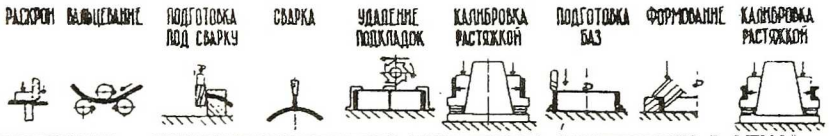
Рис. 1.1. Технологическая схема получения колец формовкой из листовой заготовки
