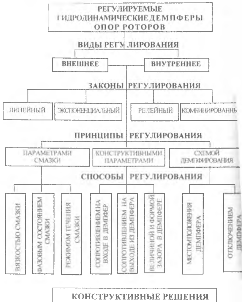
Рис.6.3. Схема обеспечения регулирования гидродинамических демпферов
