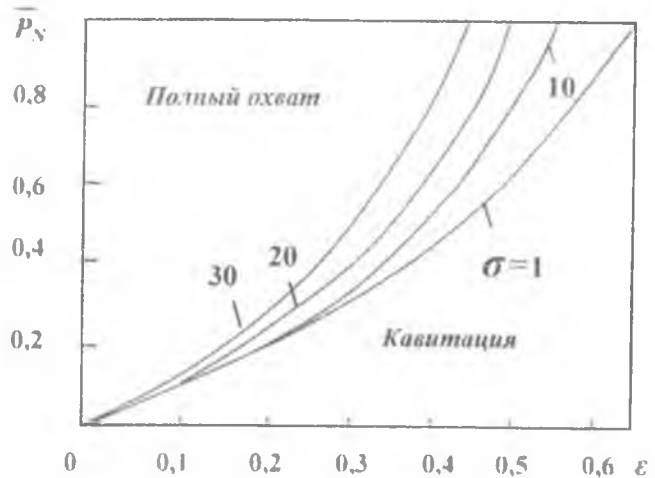
Рис. 2.25. Границы возникновения кавитации смазки при наличии зон турбулизации и различных значениях критерия \sigma и \Psi=0,002
