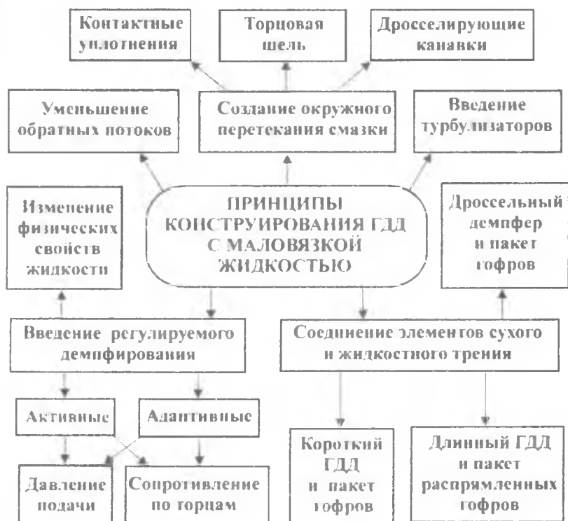
Рис. 5.2. Принципы конструирования ГДД с маловязкой жидкостью
