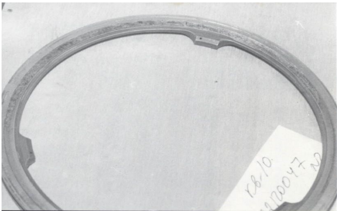
Рис.1.18. Форсуночное кольцо опоры двигателя НК-93 после дефектации
