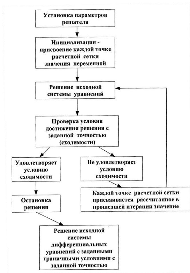
Рис. 11.6. Алгоритм решения уравнений газовой динамики численными методами
