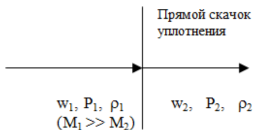
Рис.4.2 Схема течения в прямом скачке уплотнения.
