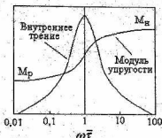
Рис. 6.5. Зависимость внутреннего трения и динамического модуля упругости от частоты колебаний
