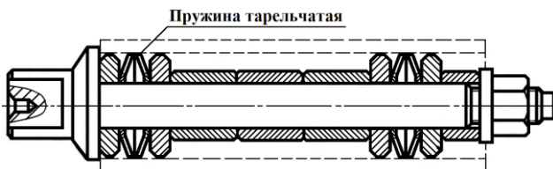
Рис. 10.3. Оправка с тарельчатыми пружинами
