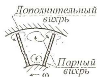
Р и с. 4.15. Схема образования дополнительного вихря
