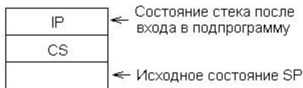
Рис. 2.17. Участие стека в механизме вызова дальней подпрограммы.
