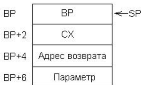
Рис. 3.8. Состояние стека в подпрограмме после сохранения регистров.
