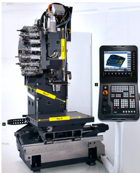
Рис. 4.4. Станина и С-рама обрабатывающего центра DMG MORI DMC 70 ecoline
