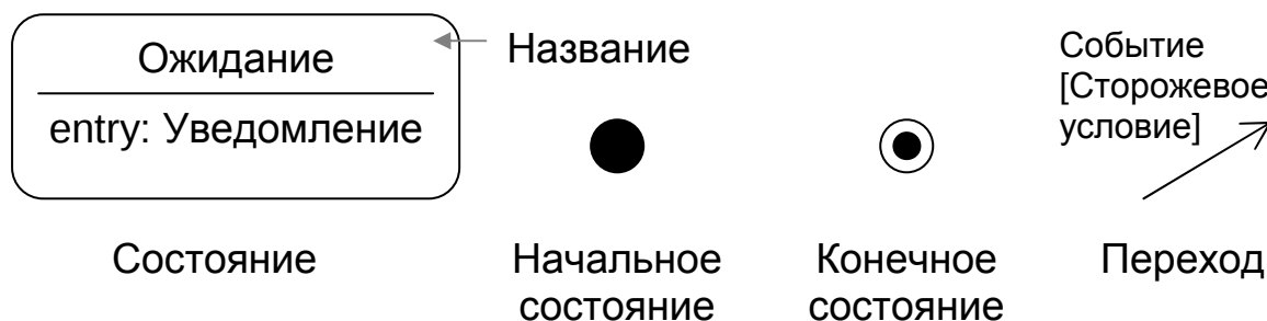
Рис. 18. Графические примитивы диаграммы состояний UML
