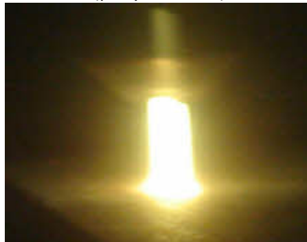
Рис.2.35. Плазменная (сжатая) дуга, горящая на графит
