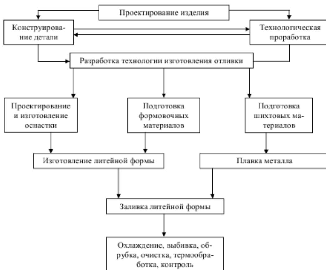
Рис. 3.5. Схема технологического процесса изготовления отливки
