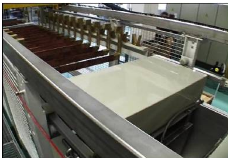
Рис. 4.2. Линия гальванического осаждения меди
