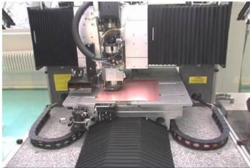
Рис. 4.11. Установка автоматического сверления
