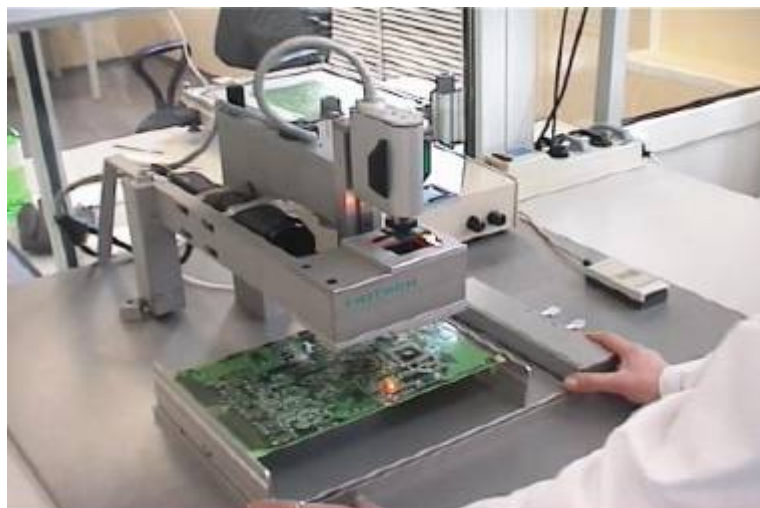
Рис. 4.8. Монтаж компонентов на печатную плату
