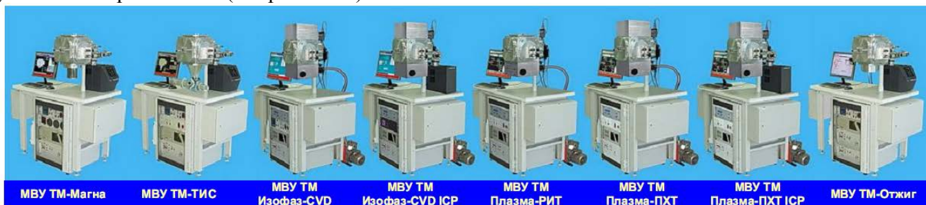
Рис. 4.39. Комплект малогабаритных вакуумных установок настольного типа “МВУ ТМ”
