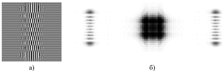
Рис. 1.5. Формирование мод ГЭ (0,9), распространяющихся под углами к оптической оси: а – фаза частично кодированного ДОЭ; б – распределение интенсивности (негатив), рассчитанное на расстоянии z=500 мм от плоскости ДОЭ
