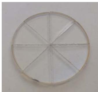
Рис. 1.15. 8-секционный поляризатор на основе полуволновых пластинок
