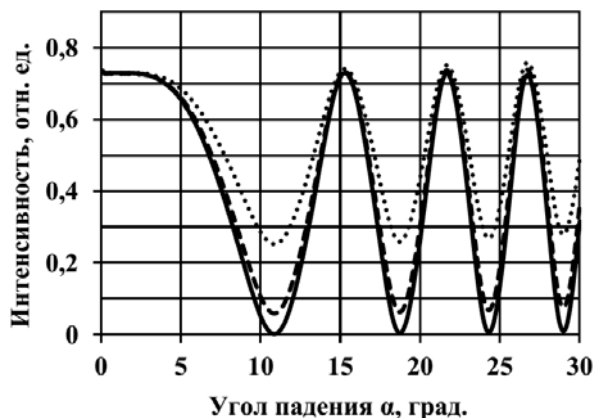
Рис.3.9. Экспериментальная зависимость I_{out}(\alpha) при различных азимутальных углах поляризатора, кристалла и анализатора: сплошная линия – \gamma_1=45^\circ, \gamma_2=0^\circ, \gamma_3=45^\circ ; штриховая линия – \gamma_1=45^\circ, \gamma_2=0^\circ, \gamma_3=30^\circ ; точечная линия – \gamma_1=45^\circ, \gamma_2=0^\circ, \gamma_3=15^\circ
