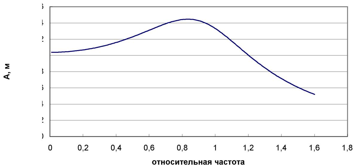
Рис. 31. АЧХ по математической модели для первой критической частоты
