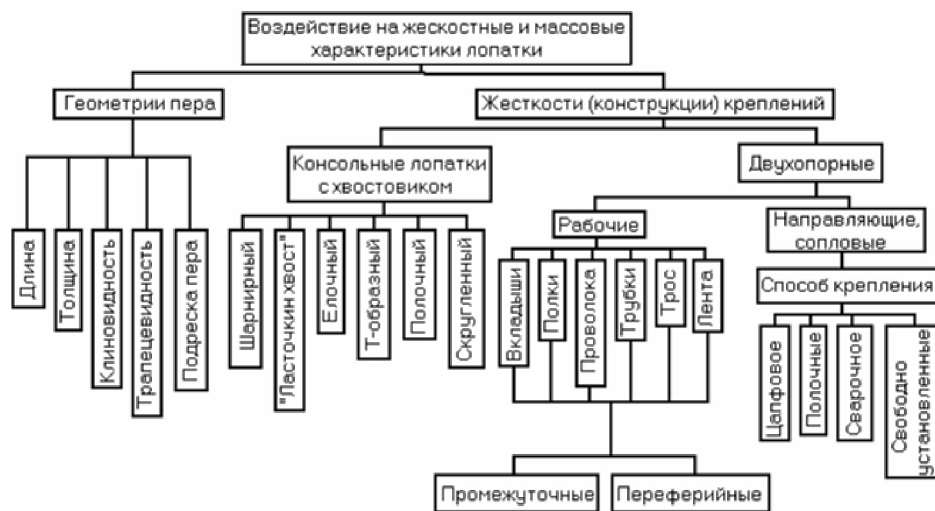
Рис. 9.4. Структурная схема воздействия на жесткостные и массовые характеристики лопатки
