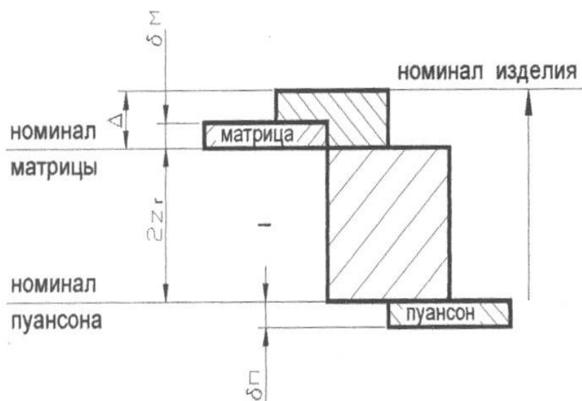
Рисунок 8 – Схемы расположения полей допусков на исполнительные размеры матрицы и пуансона при гибке детали «скоба».
