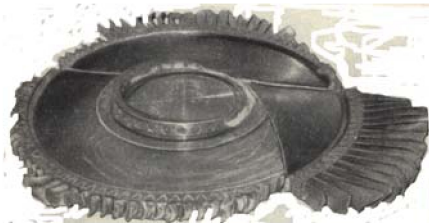
Рис.О.1. Разрушение дисков
