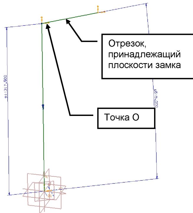
Рис. 6. Построение вспомогательных отрезков
