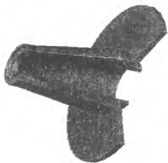
Рис.4. Трёхмерная параметрическая модель сопла ГСС
