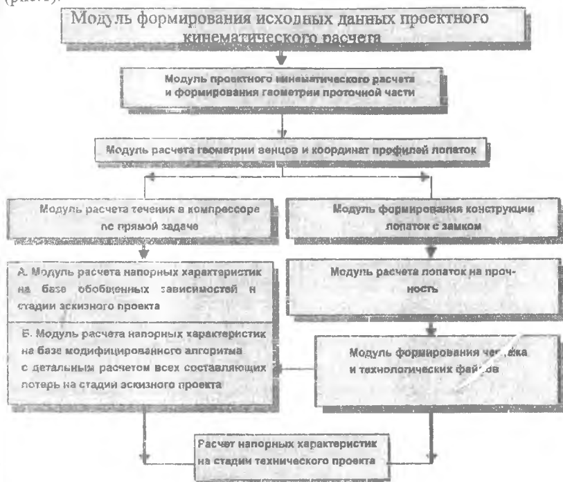
Рис. 1. Программный комплекс СНТК для проектирования и доводки осевых компрессоров в квазитрехмерной постановке
