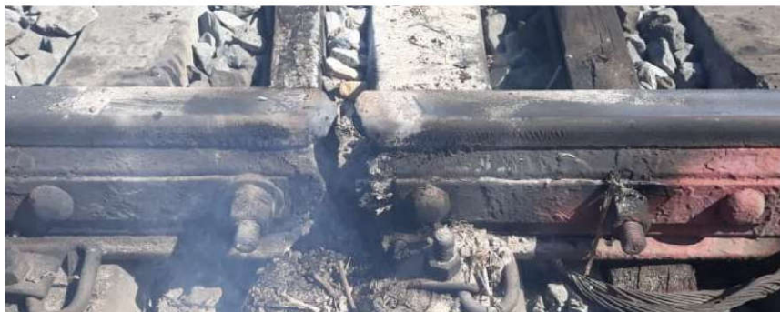
Рис. 1. Последствия воздействия повышенных токов на тяговую рельсовую сеть
