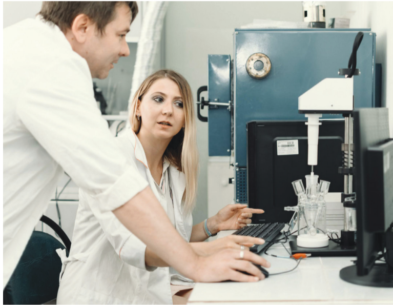
Доцент кафедры физической химии и хроматографии Роман Шафигулин и аспирант Анастасия Ядрова перед потенциостатом-гальваностатом ИПС и установкой с вращающимся дисковым электродом ВЭД-06
