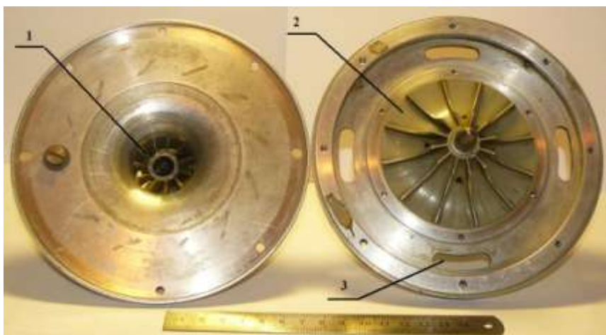
Рис. 2.2. Лабораторная установка для изучения рабочего процесса и снятия характеристик центробежного микрокомпрессора
