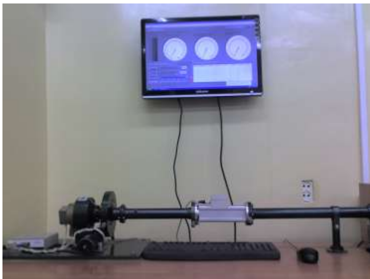
Рис. 2.2. Лабораторная установка для изучения рабочего процесса и снятия характеристик центробежного микрокомпрессора
