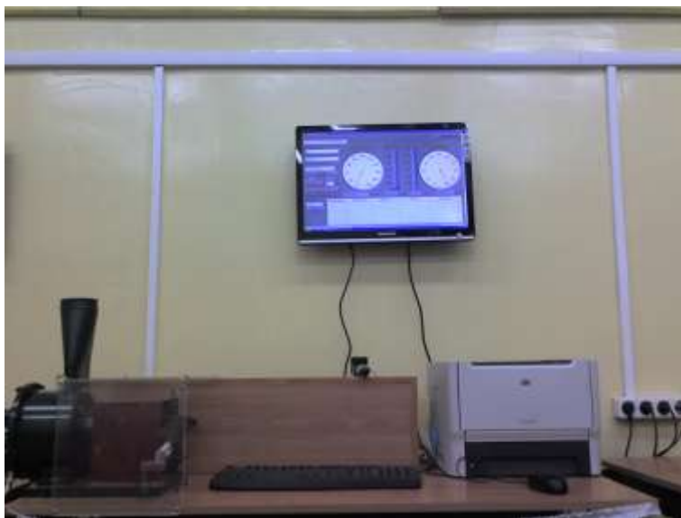
Рис. 2.2. Лабораторная установка для изучения рабочего процесса и снятия характеристик кольцевой центростремительной микротурбины
