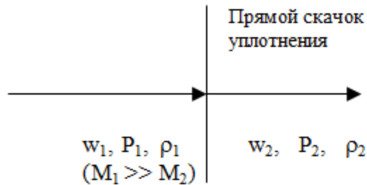
Рис.4.2 Схема течения в прямом скачке уплотнения.
