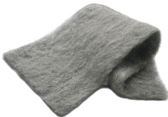
Рис.1 – Пористый волокновой металлический материал (ПВММ) из сплава типа X23Ю5, полученный методом ЭВКР
