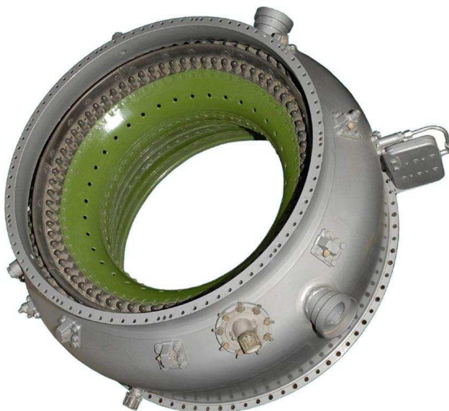
Рисунок 3 - Кольцевые камеры сгорания двигателей, созданных под руководством Н.Д.Кузнецова.
